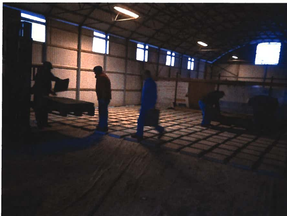
Kép: betonelem gyártása, osztályozása, raklapra pakolása
